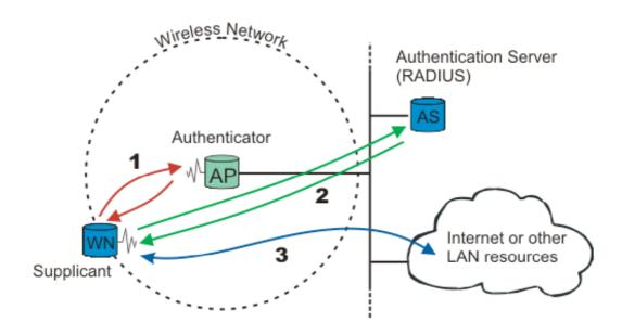
De esta manera, el protocolo 802.1x provee una manera efectiva de autentificar, se implementen o no claves de autentificación WEP. De todas formas, la mayoría de las instalaciones 802.1x otorgan cambios automáticos de claves de encriptación usadas solo para la sesión con el cliente, no dejando el tiempo necesario para que ningún programa de capturas de tramas sea capaz de obtener la clave.
